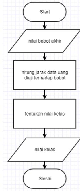
Gambar 3. Flowchart pengujian LVQ
