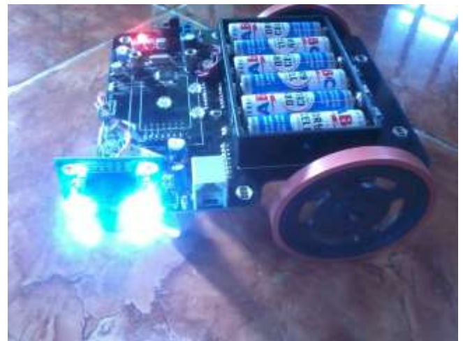
Gambar 16, Robot Mulai dinyalakan bersamaan dengan sensor TCS3200
