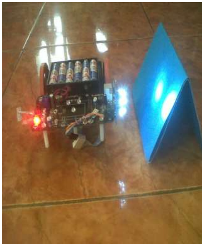
Gambar 18, Robot Mendeteksi warna biru
