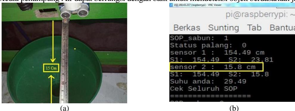
Gambar 6. Pengujian Sensor Ultrasonik (a) Media Penampung Air, (b) Hasil pada terminal
