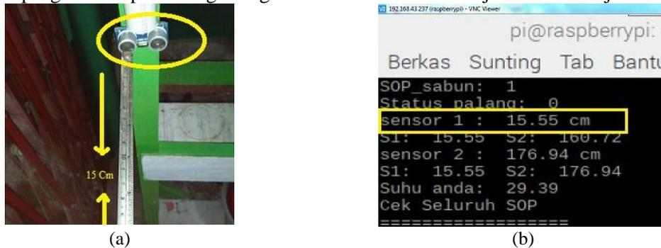
Gambar 5. Hasil Pengujian Sensor Ultrasonik (a) Instalasi, (b) Hasil pada terminal
