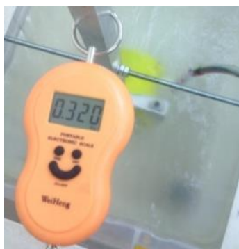
Gambar 14 Pengujian Thruster ROV
